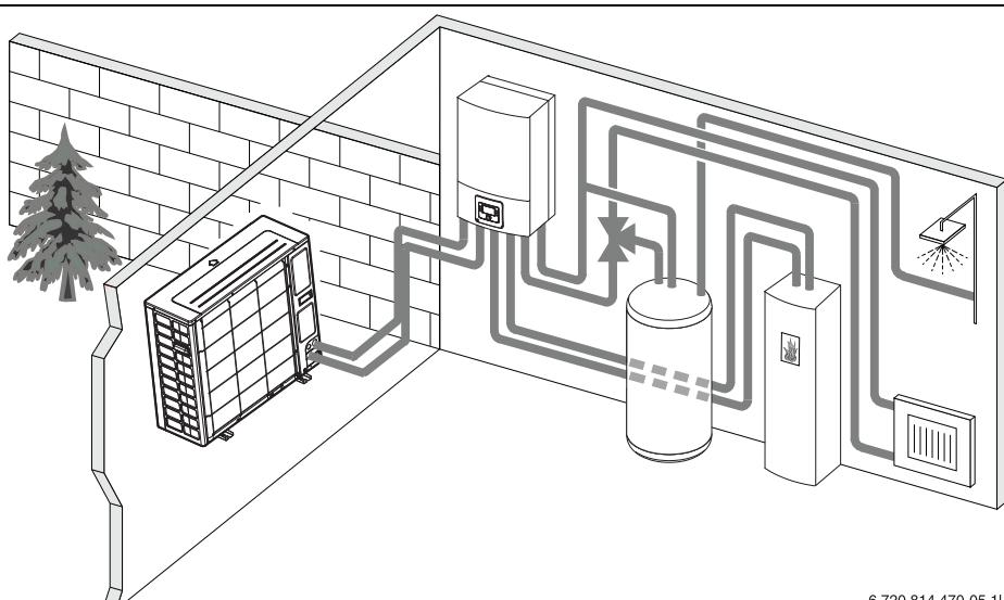
sl. 2 Toplotna pumpa spoljne jedinice, unutrašnja jedinica AWBS bez električnog dogrevača, eksterni bojler za toplu vodu i eksterni dogrevač
