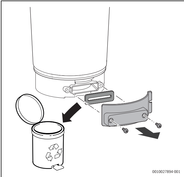
sl. 67 Otvaranje kontrolnog otvora
