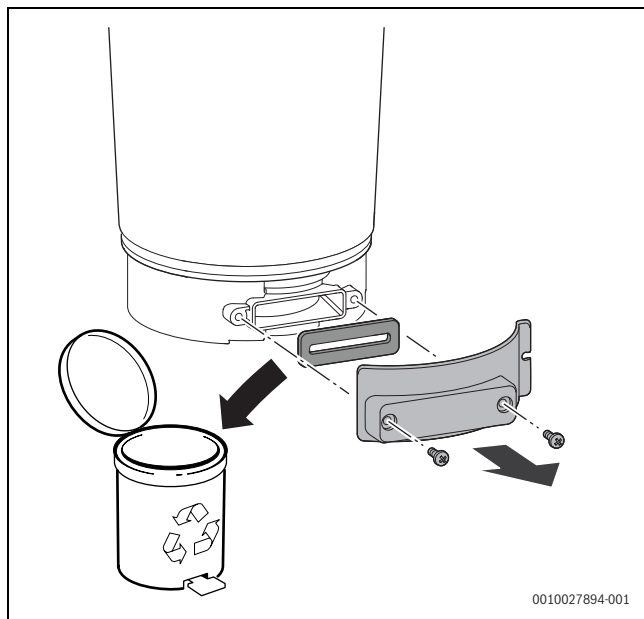
sl. 68 Otvaranje kontrolnog otvora
